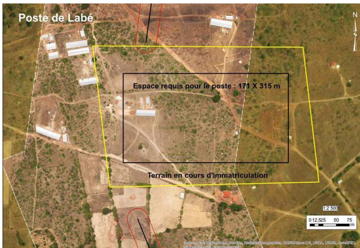
Figure 3.6 : Espace occupé par le poste à l'intérieur de l'emprise réservée.
